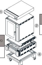
3 One EMT module Height: 315 mm/module.
